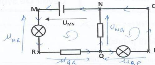
1/ a- Représenter le sens du courant et les flèches tensions suivantes :  $U_{NQ}$ ;  $U_{MR}$ ;  $U_{QR}$  et  $U_{QP}$ . (1pt)
